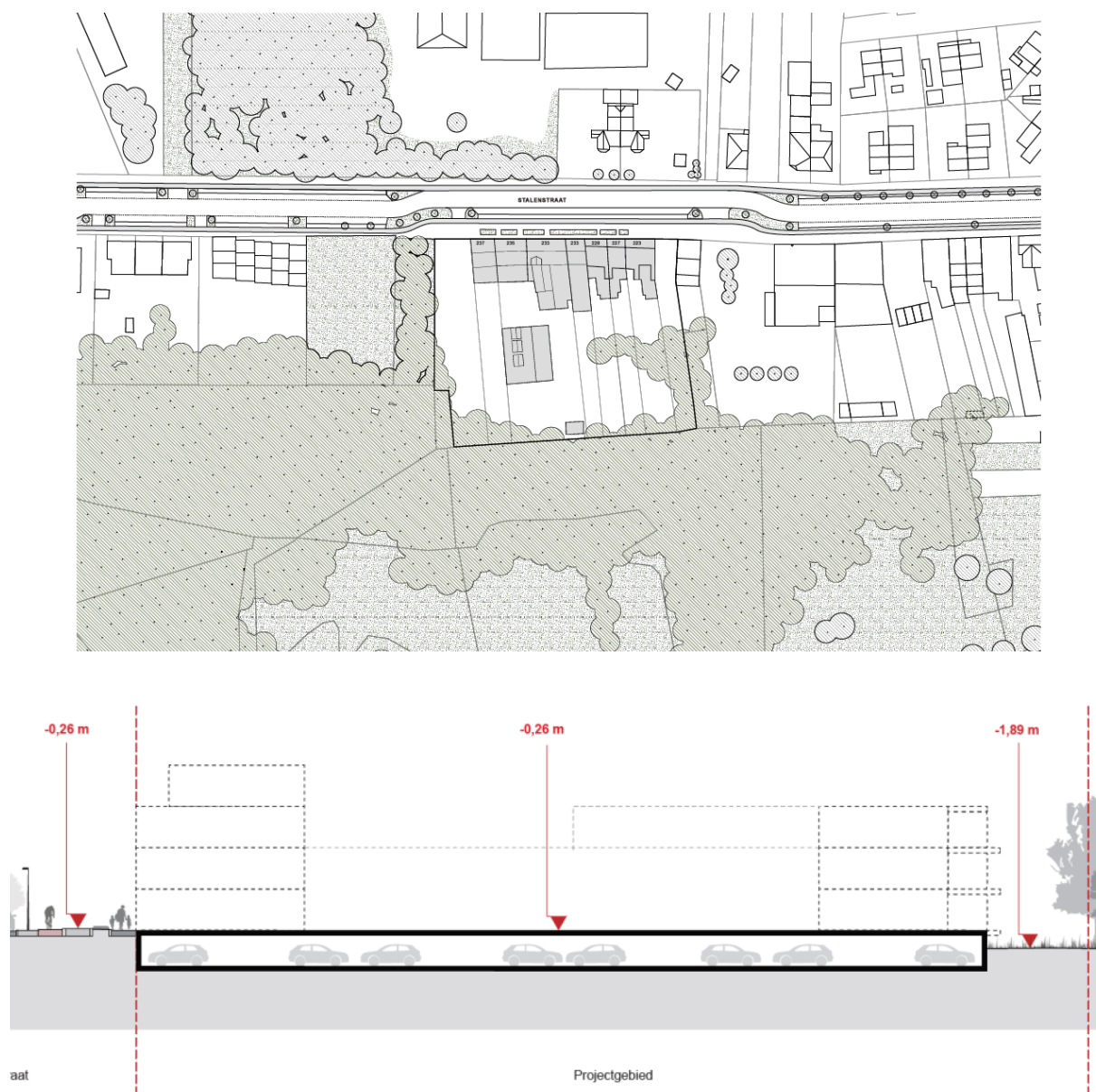
Fig. 1.3: Huidige toestand en de geplande werken (doorsnedes) (bron: Aannemingen Janssen nv).
