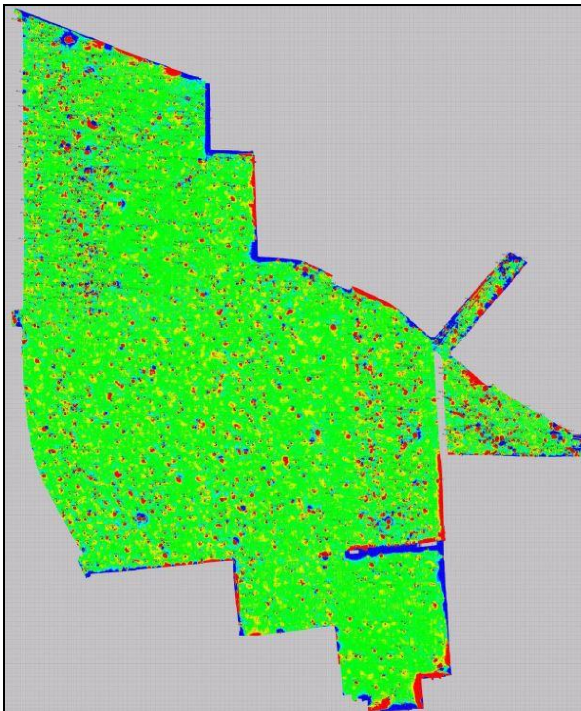
Figuur 11: De uitgevoerde magnetmetrische bodemscan met zicht op de potentiële explosieven (combinatie rood-blauw) binnen het plangebied (© bomBE)
