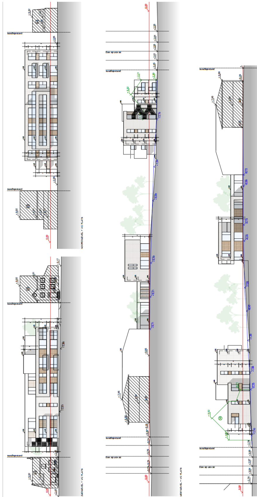
Figuur 9: Geveldoorsnedes van het toekomstige appartementsblok 27
