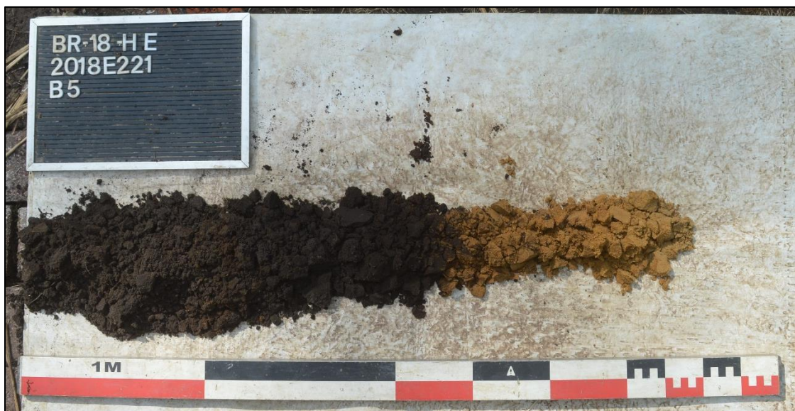
Afb. 22: Referentieprofiel BP5 met boorprofiel Ophoging-A-C (Bron: Aron bvba, dd. 24/05/2018, 2018E221).
