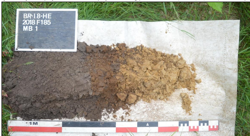
Afb. 31: Referentieprofiel MB1 met boorprofiel A-Bs-Cg (Bron: Aron bvba, dd. 21/06/2018, 2018F185).
