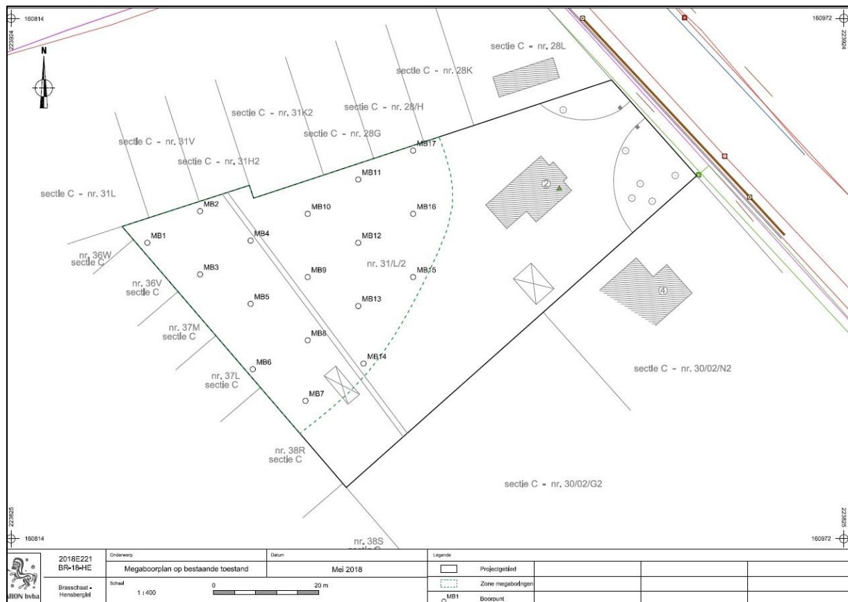
Afb. 27: Boorplan voor het verkennend booronderzoek op bestaande toestand (BT) (Aron bvba, dd. 25/05/2018, digitaal plan, aanmaatschaal 1.400, 2018F185).
