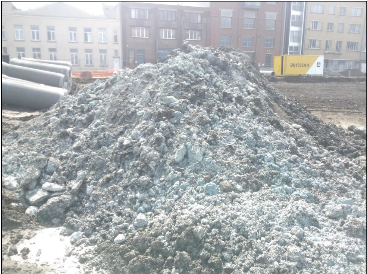
Figuur 17: Ondergronds gipsafval in de Cadixwijk (bron: ABO 2013)
