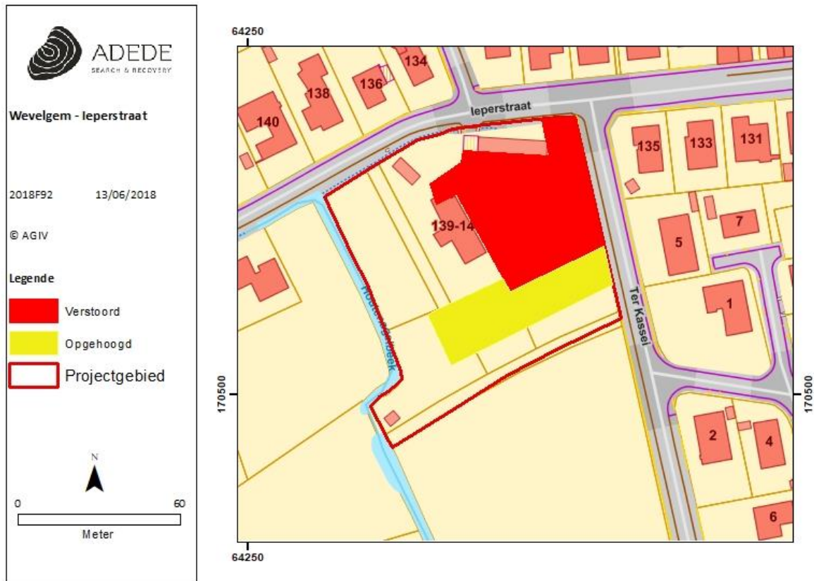
Figuur 27. Vastgestelde verstoringen adhv. Controleboringen en terreinbezoek
