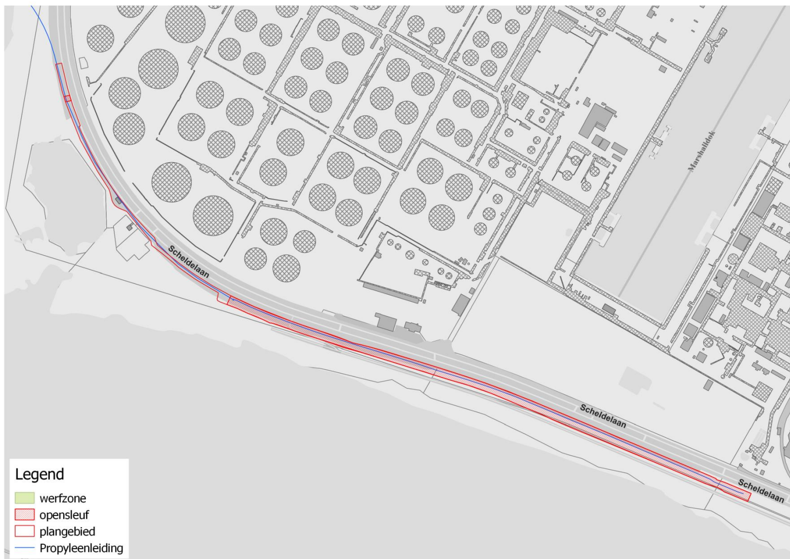
Figuur 10: Plangebied ter hoogte van rechtoever met aanduiding van de leiding, de open sleuf en de werfzone.
