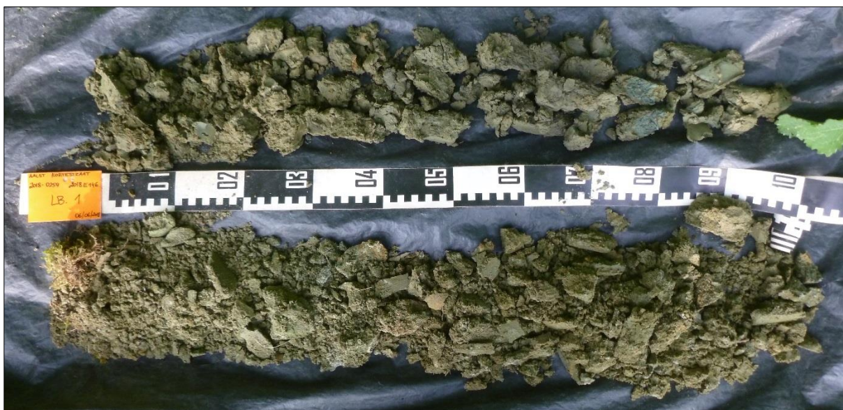
Foto 3: Boring 1 van 0 cm links beneden tot 200 cm rechts boven (©BAAC).
