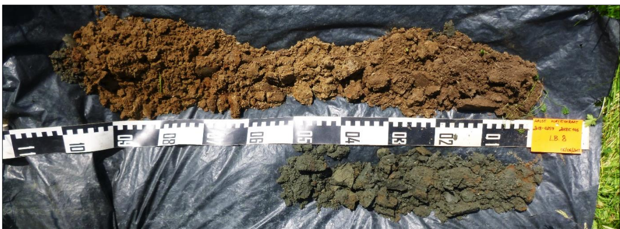
Foto 13: Boring 8 van 0 cm rechts boven tot 150 cm centraal beneden (©BAAC).
