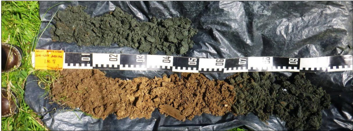
Foto 12: Boring 7 van 0 cm links beneden tot 150 cm centraal boven (©BAAC).
