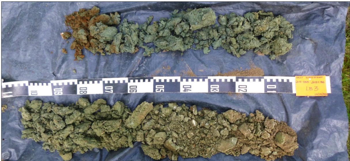
Foto 9: Boring 3 van 0 cm rechts beneden tot 180 cm links boven (@BAAC).
