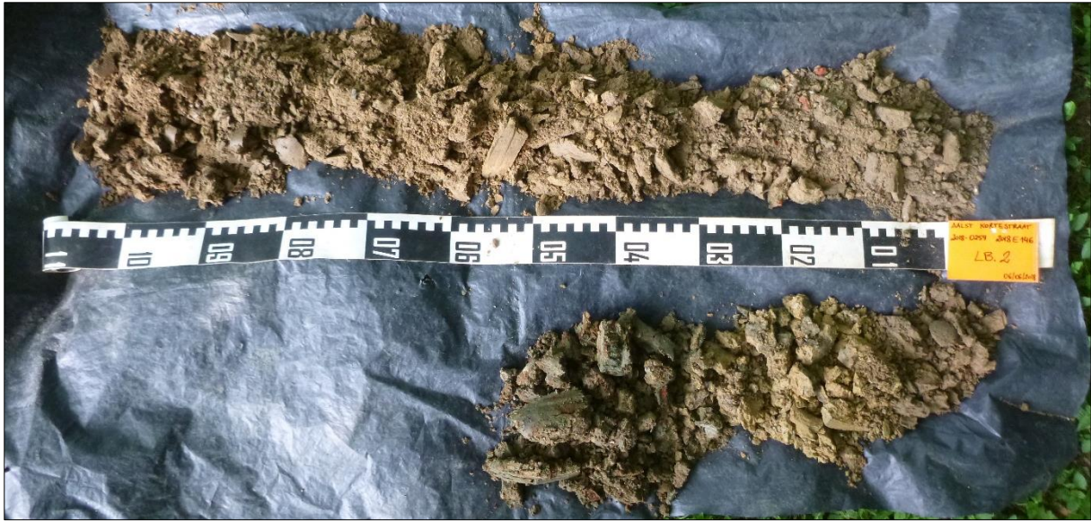
Foto 5: Boring 2 van 0 cm rechts boven tot 150 cm centraal beneden (©BAAC).
