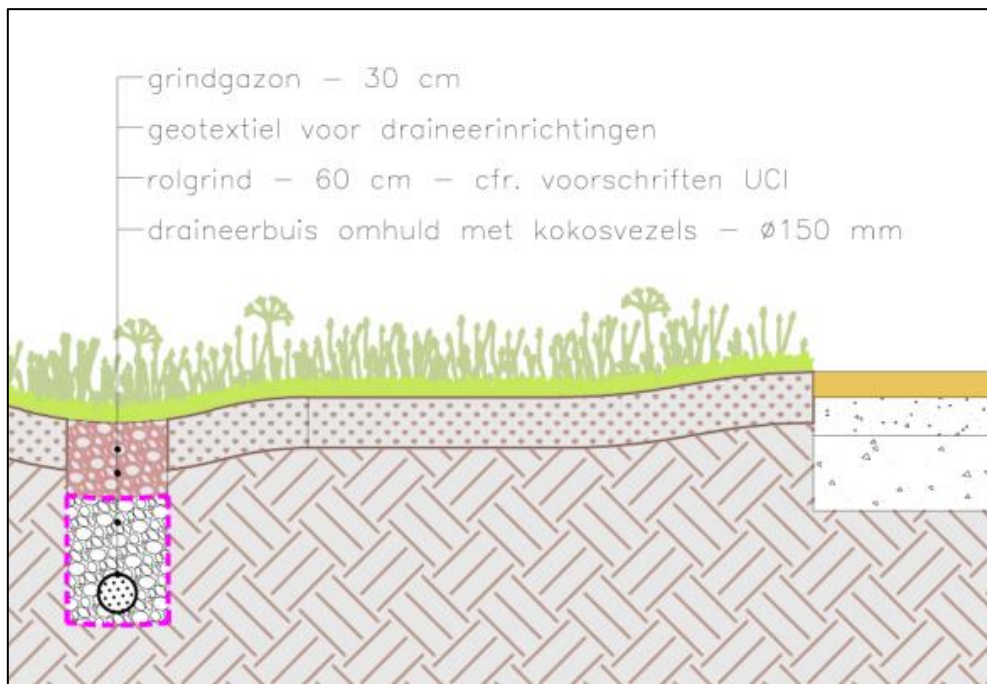
Figuur 10: Opbouw drainage BMX-parcours
