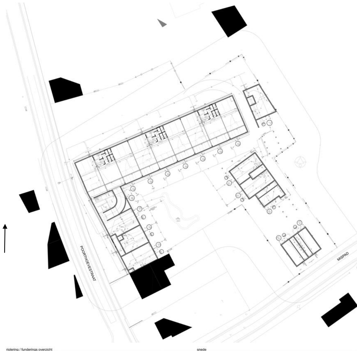
Afb. 26. Overzicht van de fundering en de riolering
