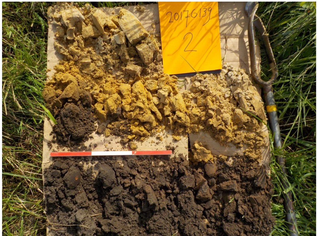
Afb. 9. Boring 2 (uitgelegd van onderen naar boven: 0-50cm, 50-100cm, 100-125cm).
