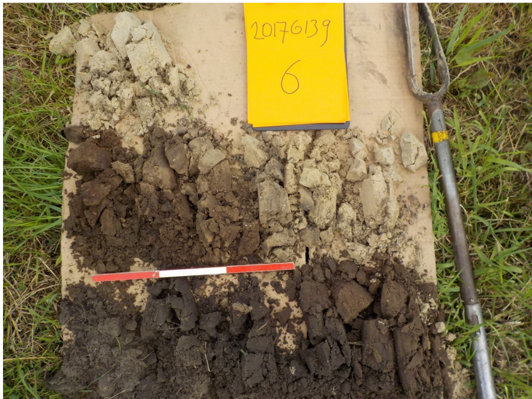
Afb. 8. Boring 6 (van onderen naar boven uitgelegd: 0-50 cm, 50 –100cm, 100-125cm).
