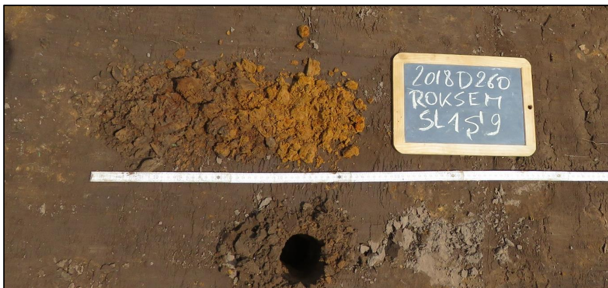
Figuur 62 Boring op de greppel S9 in sleuf 1. De C-horizont bevindt zich op ca. 25cm.
