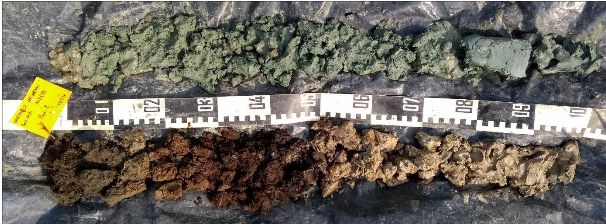
Foto 4: Boring 2 van 0 cm links beneden tot 200 cm rechts boven (©BAAC).
