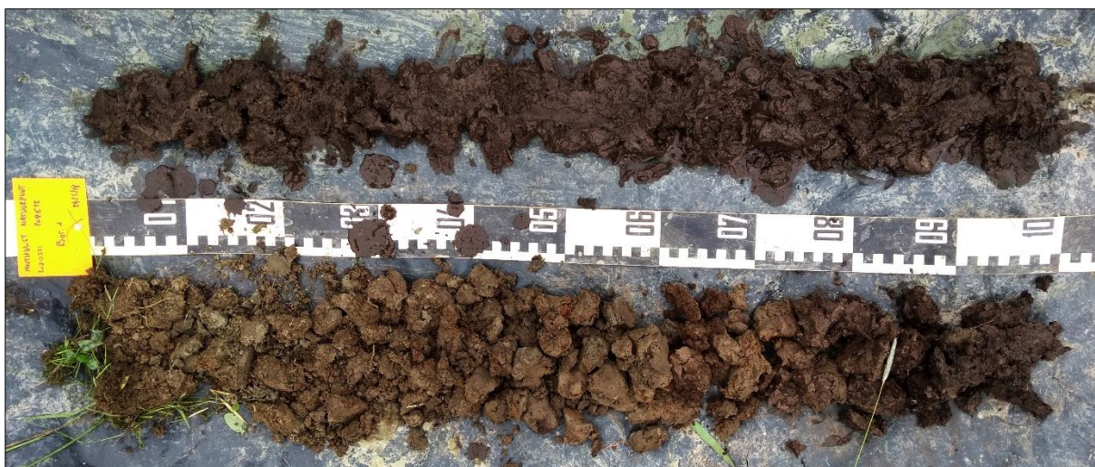
Foto 2: Boring 1 van 0 cm links beneden tot 200 cm rechts boven (©BAAC).
