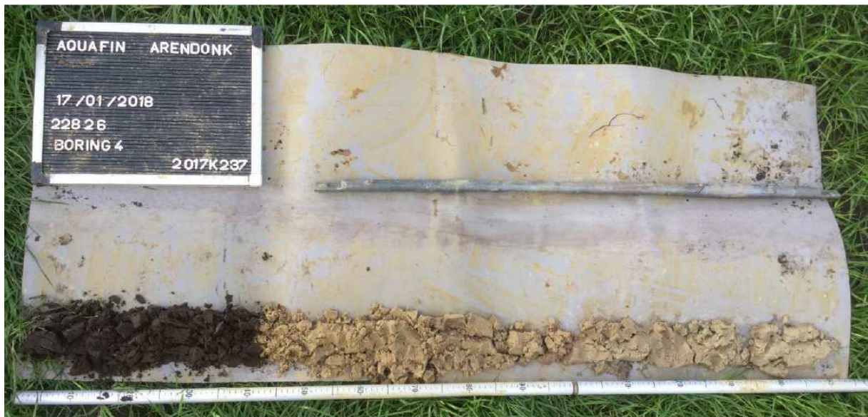
Figuur 10: Boring 4 langs de Broekstraat te Arendonk (Geosonda 2018).
