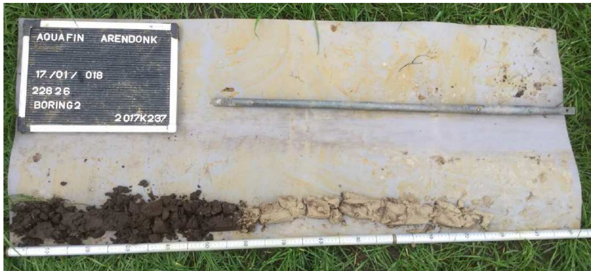
Figuur 6: Boring 2 langs de Broekstraat te Arendonk (Geosonda 2018).
