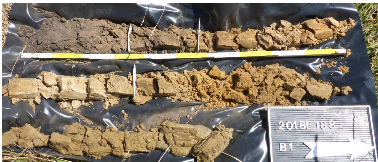
Figuur 28 Foto boring 1 met aanduiding van de herkende horizonten (GATE)
