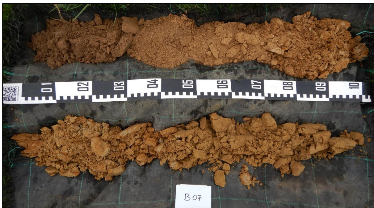
Figuur 31: Weergave van BP7 dat als referentie kan gebruikt worden voor de overige boringen. De top van het maaiveld bevindt zich linksboven, de onderkant van de boring rechtsonder (200cm -mv).
