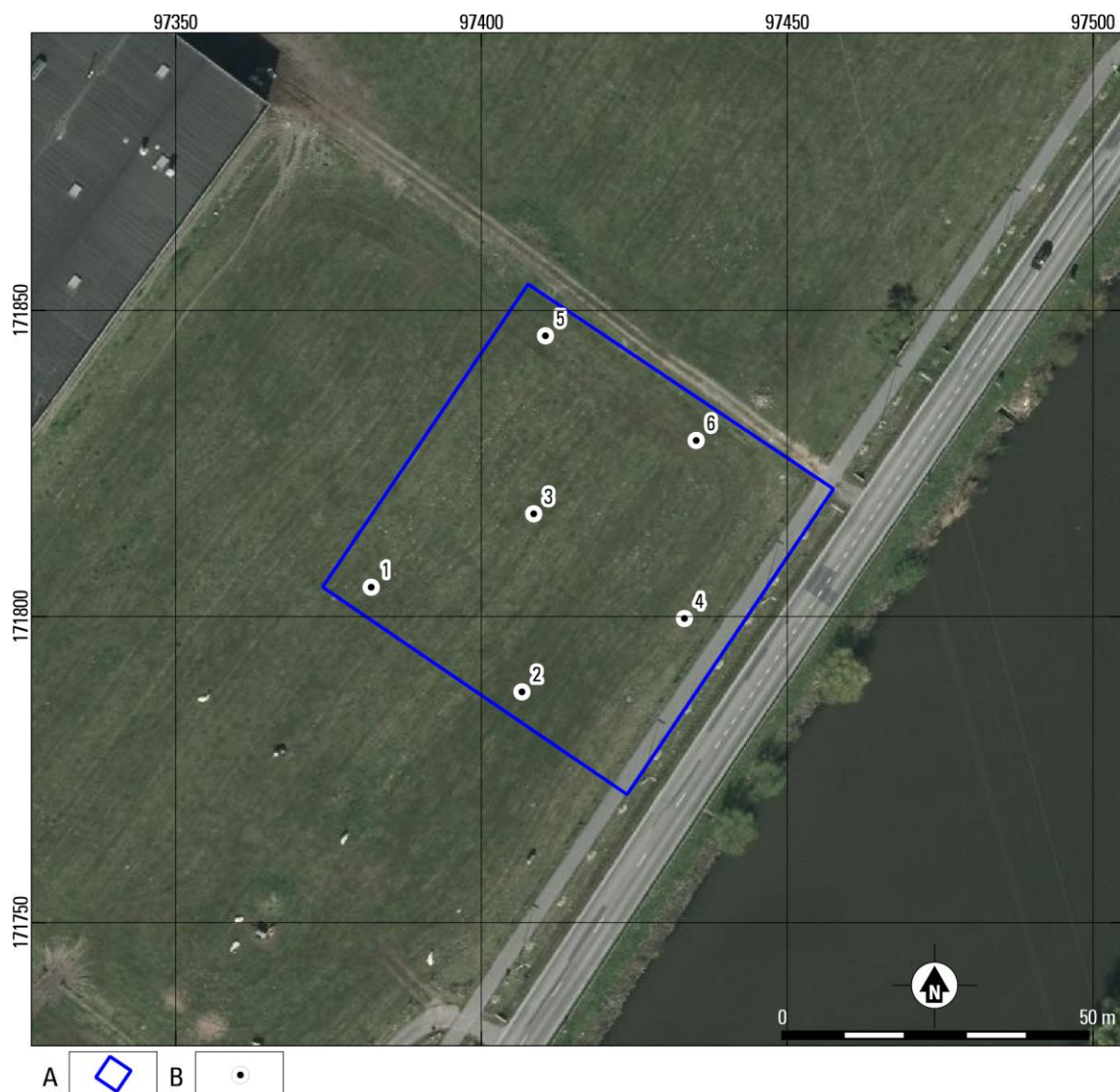
Fig. 2.1. Oudenaarde – Ontdubbeling verbindingstriolering Rietgracht (22.812). Locaties van de boringen, geprojecteerd op een recente luchtfoto. Bron: geopunt.be
