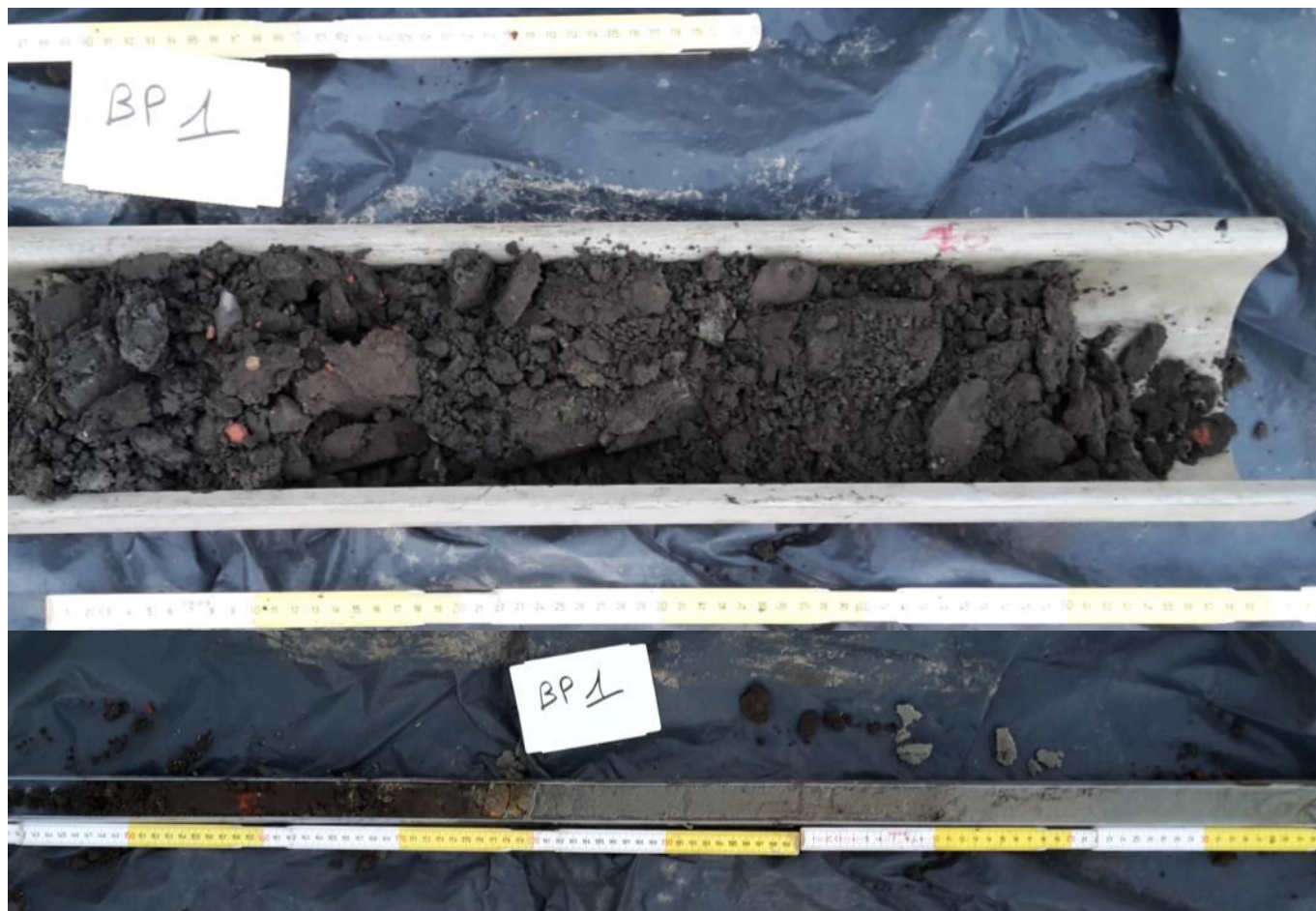
Figuur 25: Foto BP1 met sterk verstoorde bodem met tot 180 cm-mv baksteen en steenpuin met zwart zand.
