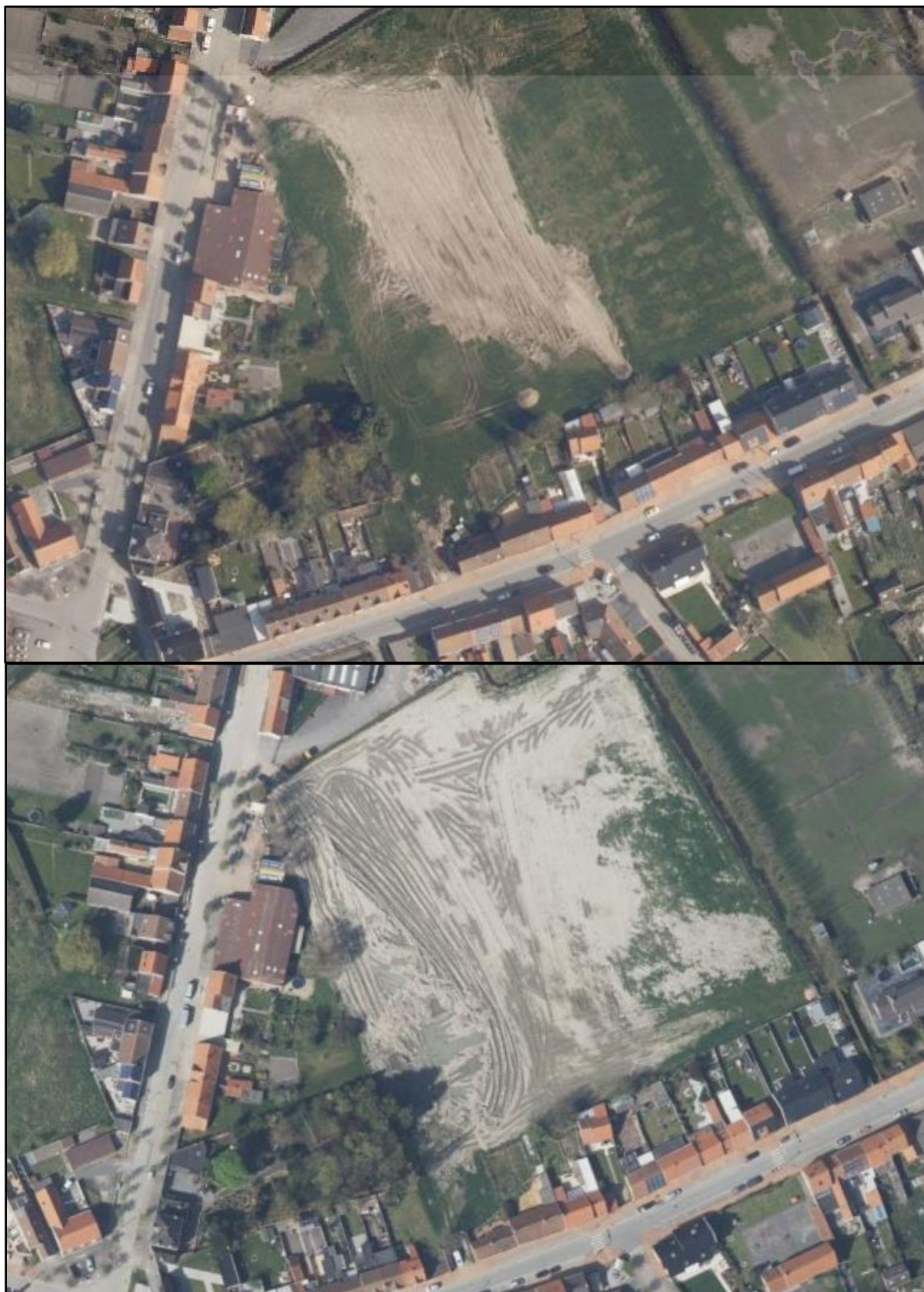
Figuur 25 Grote grondwerken op het grootste deel van het plangebied en de gronden ten noorden, luchtfoto uit 2015 (boven) en 2016 (onder) (bron: geopunt).
