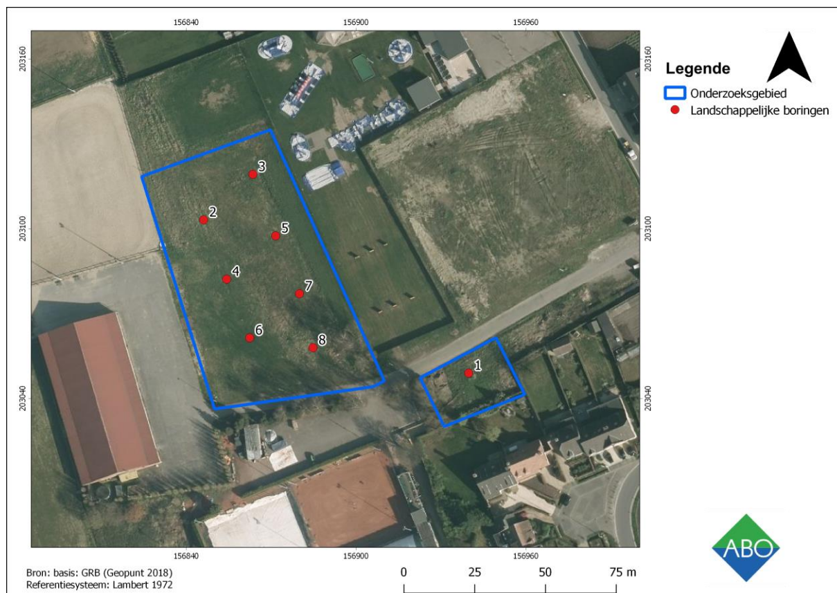
Figuur 44: Orthofoto met aanduiding van de uitgevoerde landschappelijke boringen (Bron: ABO nv 2018)
