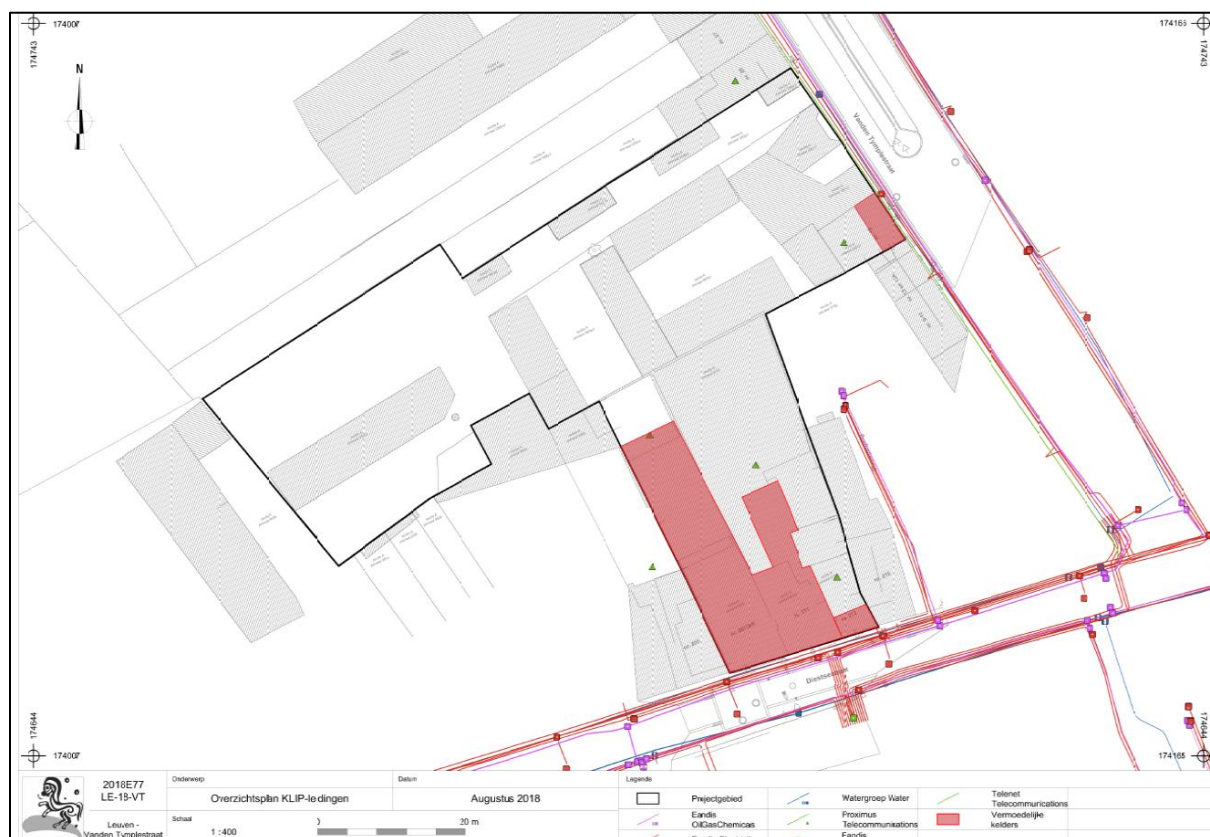
Afb. 28: Overzicht aanwezige nutsleidingen op het onderzoeksterrein (Bron: KLIP, digitaal plan, dd 02/08/2018, aanmaatschaal 1.400, 2018E77).
