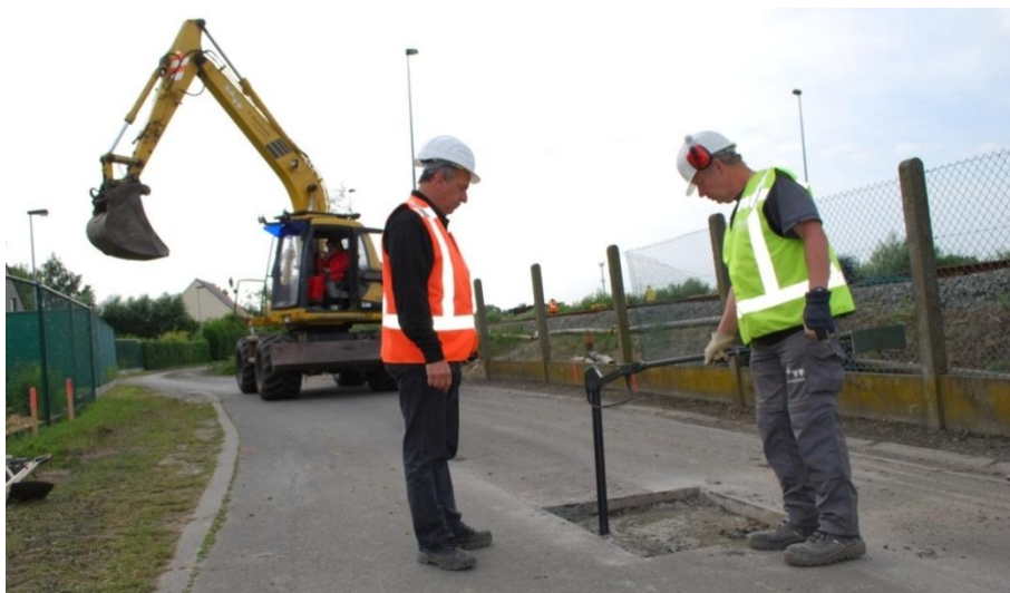
Figuur 24 : Magnetometer met enkelvoudige sonde. (archief Bom-Be)
