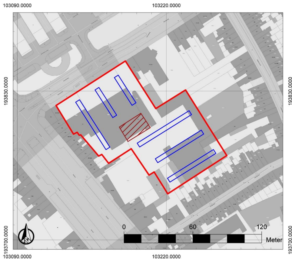
Figuur 4: Inplanting van de proefsleuven (blauw) en aanduiding van de kelder (bordeaux)
