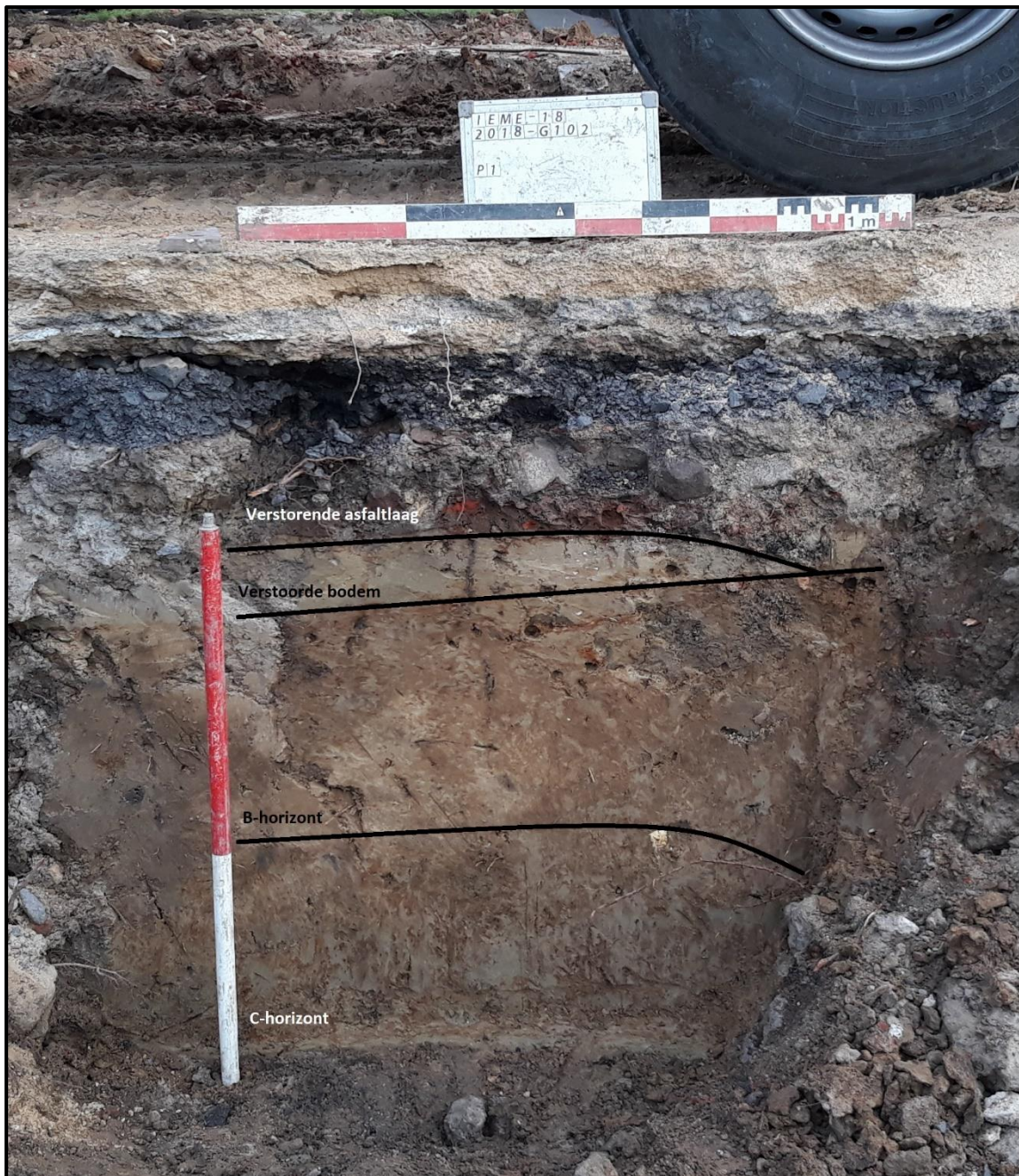
Figuur 7: Bodemprofiel 1, buiten de sleuven (zie figuur 16 en 18 en bijlage 3 en 3B). De bodemontwikkeling is hier duidelijk zichtbaar, met een verstorende asfaltlaag, een verstoorde bodem en een zandige zandlemige B-horizont bovenop de lemige zandlemige C-horizont (© Monument Vandekerckhove).
