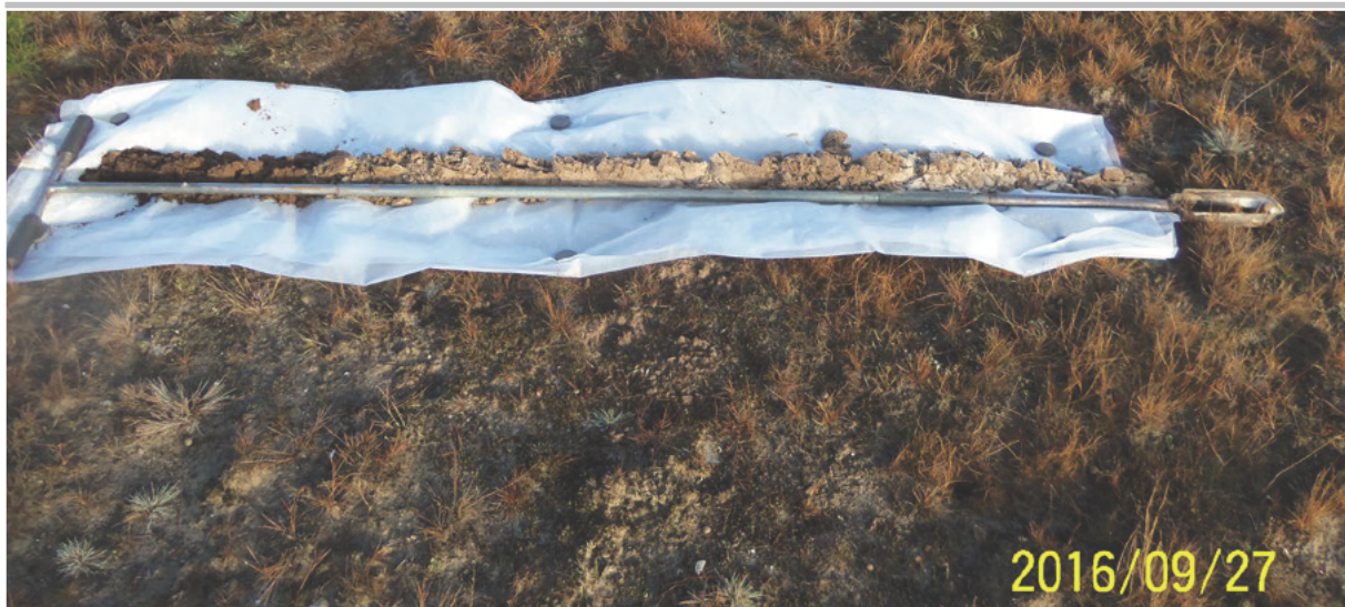
Fig. 2.6: Profiel ter hoogte van windturbine 1.
