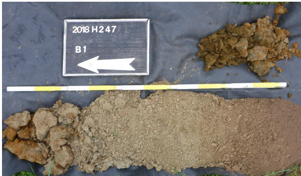
Figuur 13 Voorbeeld van een boring waarbij alle geregistreerde horizonten aanwezig zijn. Van boven naar onder gaat het om de opeenvolging van: teelaarde, B- horizon, C1- horizon (alluviale zandleem) en C2- horizon (Tertiaire afzetting)
