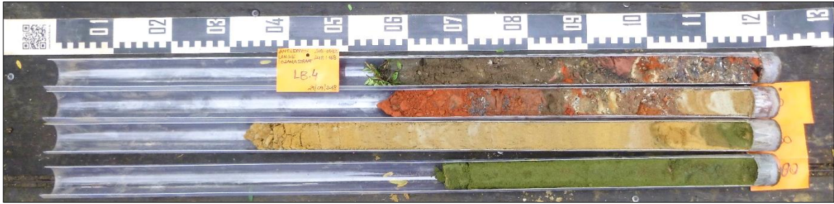
Foto 9: Boring 4 van 0 cm centraal boven tot 400 cm rechts beneden. De eerste drie liners bevatten een gecompacteerd materiaal van 120 cm, respectievelijk (van boven naar beneden) tussen 0 en 120 cm, tussen 120 en 240 cm en tussen 240 en 360 cm onder het maaiveld. De onderste liner bevatte 40 cm van afzettingen tussen 360 en 400 cm onder het maaiveld. (©BAAC)
