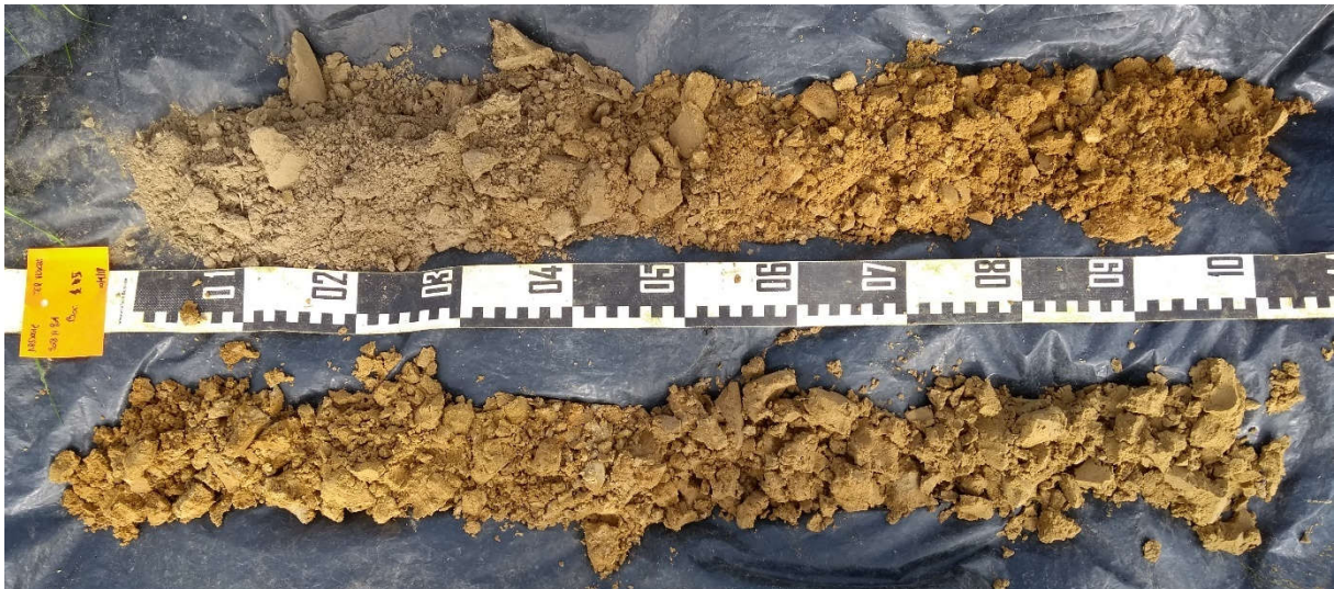
Foto 6: Boring 5, van 0 cm (linksboven) tot 200 cm (rechtsonder). (©BAAC)
