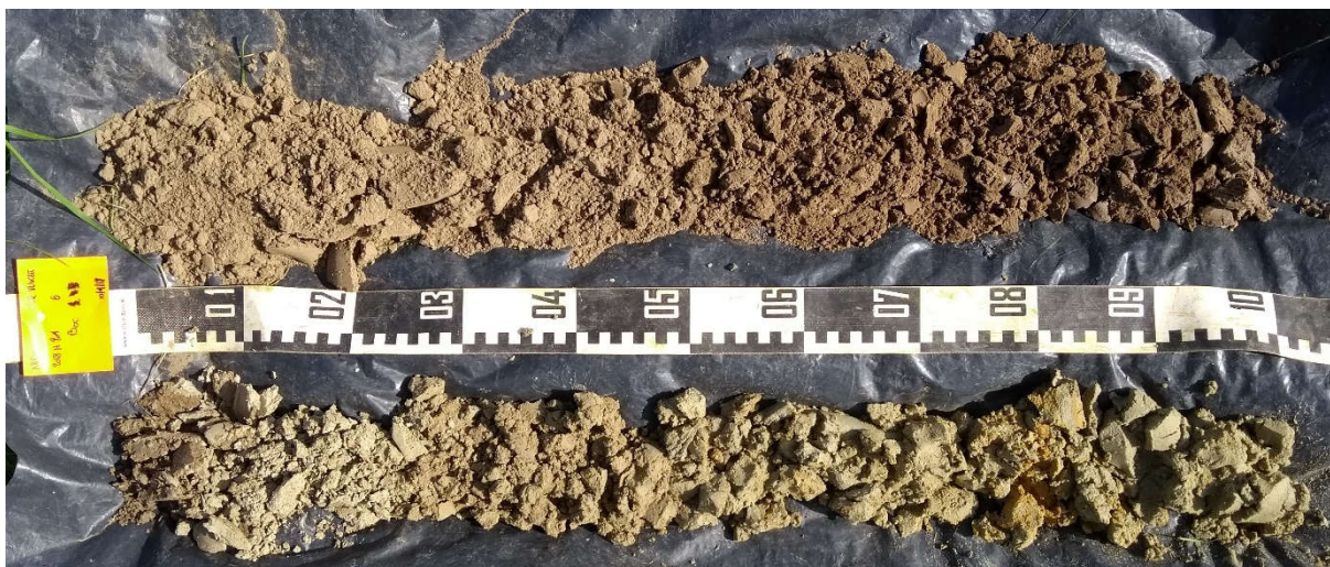
Foto 11: Boring 6, van 0 cm (linksboven) tot 200 cm (rechtsonder). (©BAAC)
