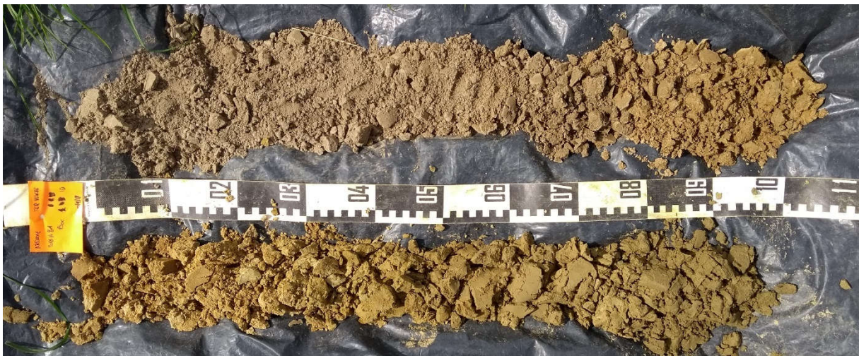
Foto 10: Boring 10, van 0 cm (linksboven) tot 200 cm (rechtsonder). (©BAAC)
