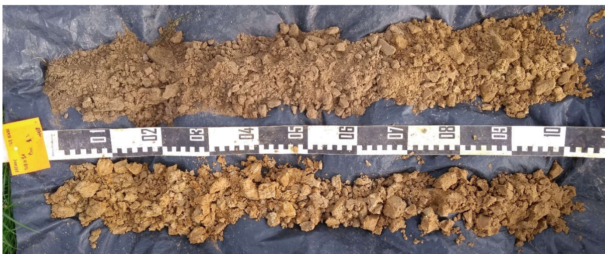
Foto 4: Boring 3, van 0 cm (linksboven) tot 200 cm (rechtsonder). (©BAAC)
