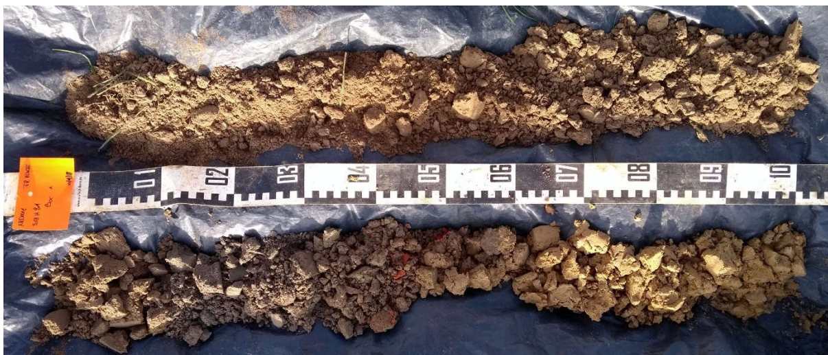
Foto 3: Boring 1, van 0 cm (linksboven) tot 200 cm (rechtsonder). (©BAAC)
