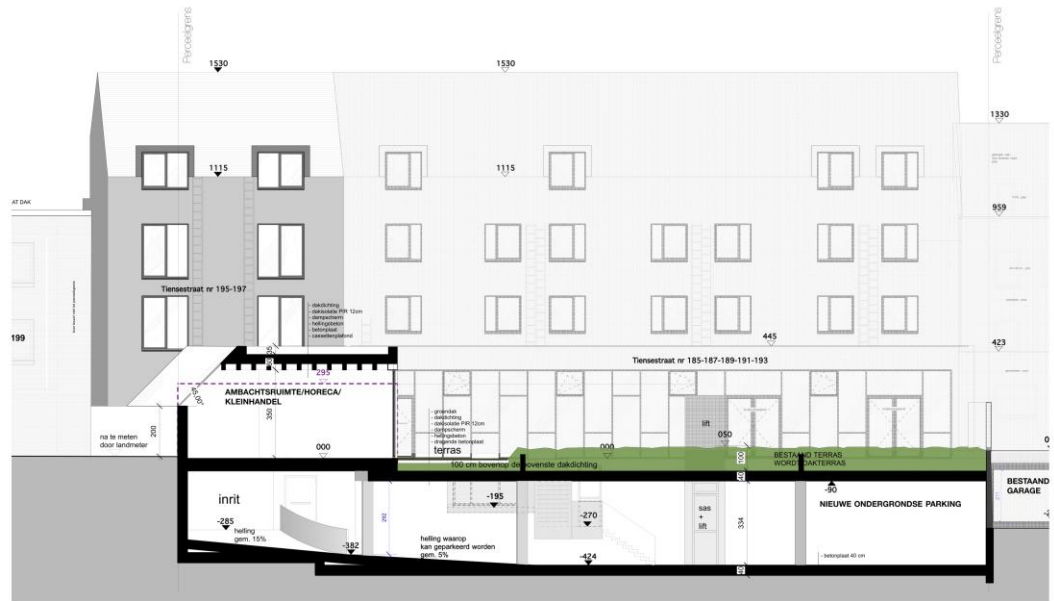
Afb. 17. Doorsnede 2 van de ondergrondse parking.
