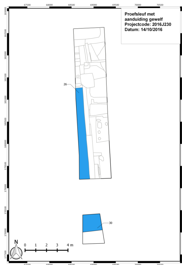
Figuur 13. Proefsleuf met aanduiding van het gewelf. Segment 2: een deel van de oostelijke keldermuur werd ook ingekleurd als gewelf. De aanzet van de muur kon niet exact ingemeten worden tijdens het huidig onderzoek.
