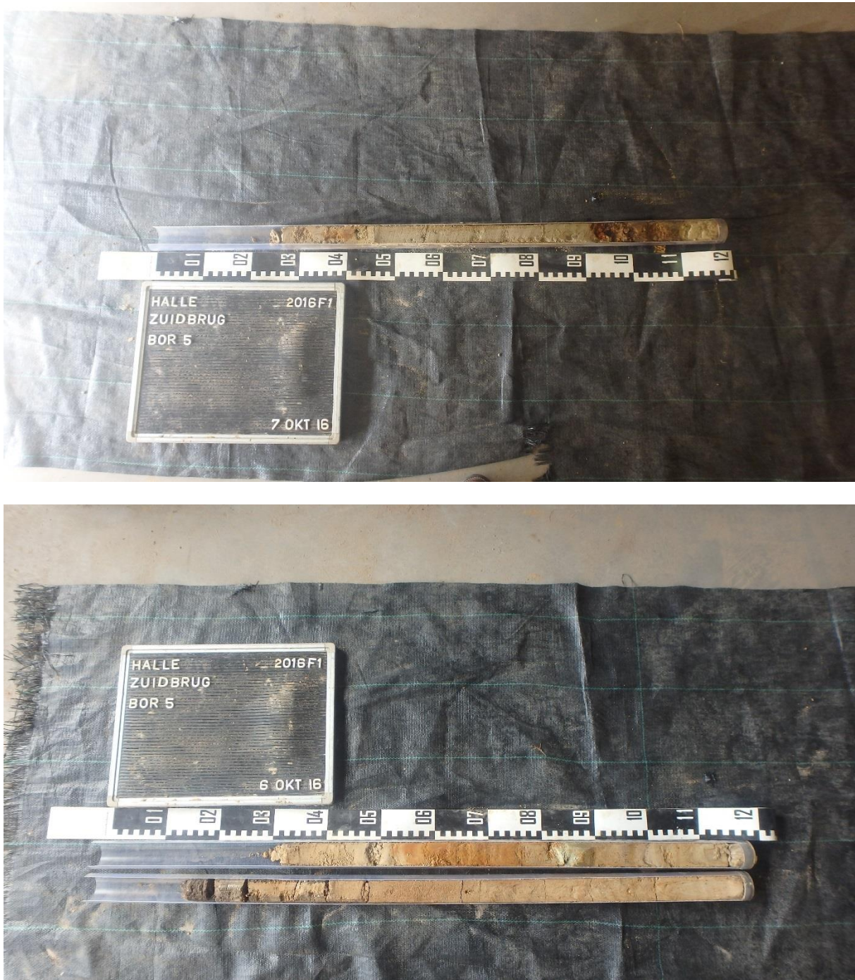
Figuur 39: Boring 5, liners gesorteerd van onder (0-240 cm -mv) naar boven (240-340 cm -mv) (Foto: 6-10-2016)
