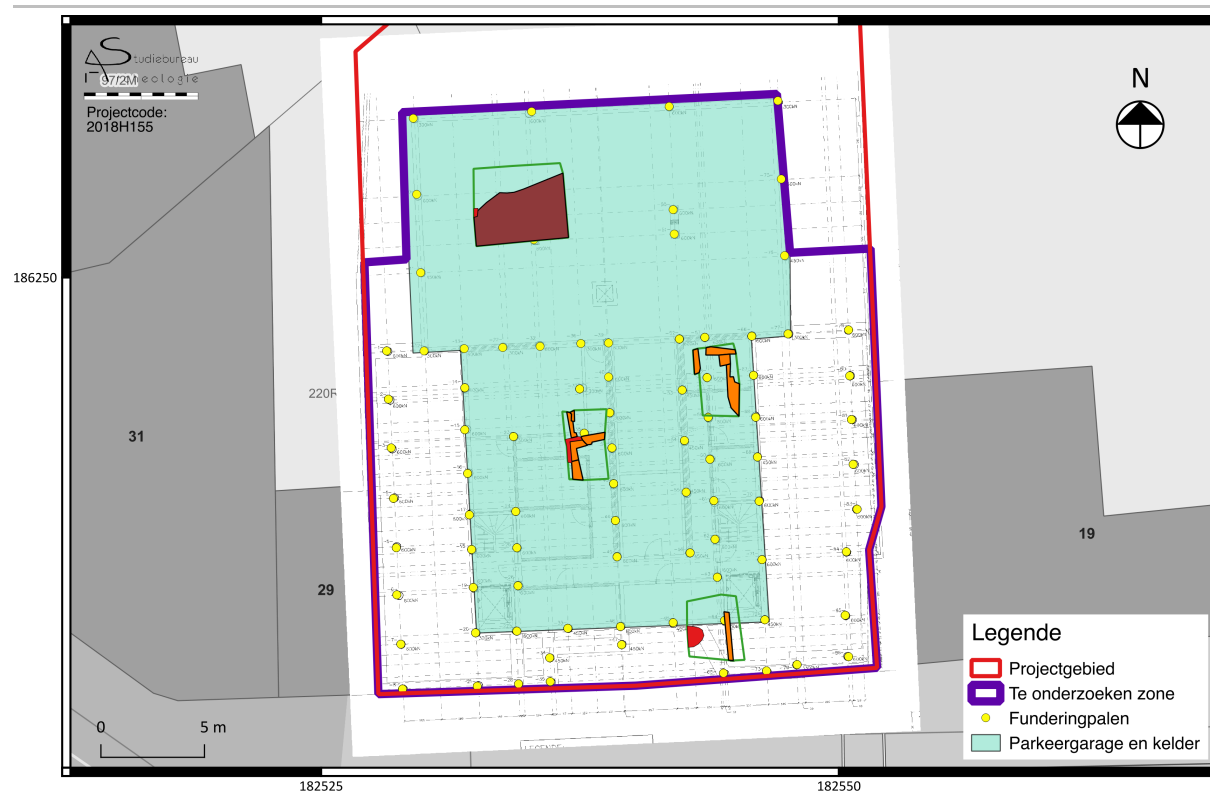
Fig. 3.3: Impactbepaling: alle-sporenplan geplot op het funderingsplan.
