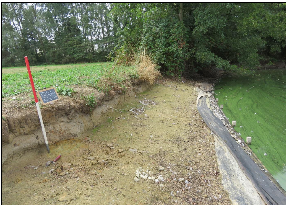
Figuur 13 De oeverrand van de grote vijver in het zuidoosten met zicht op de bodemopbouw links. De C-horizont bevindt zich op ca. 45 tot 50cm diepte.
