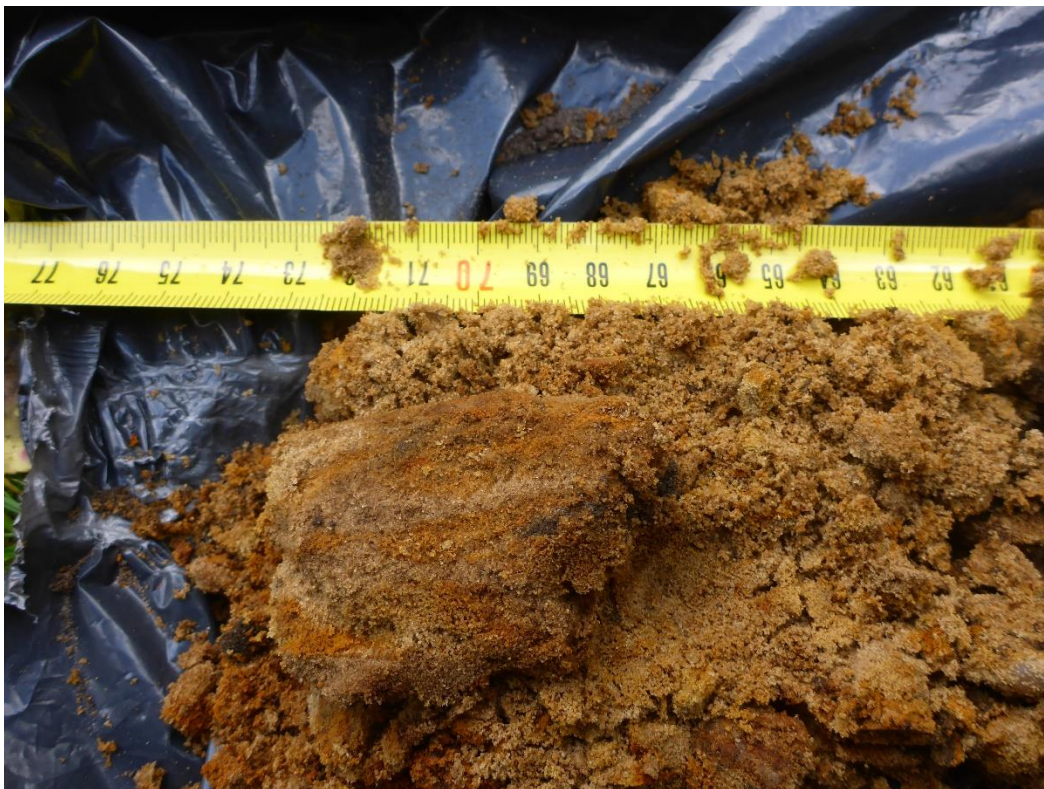
Figuur 52: Detail van de verstoorde laag in boring 6
