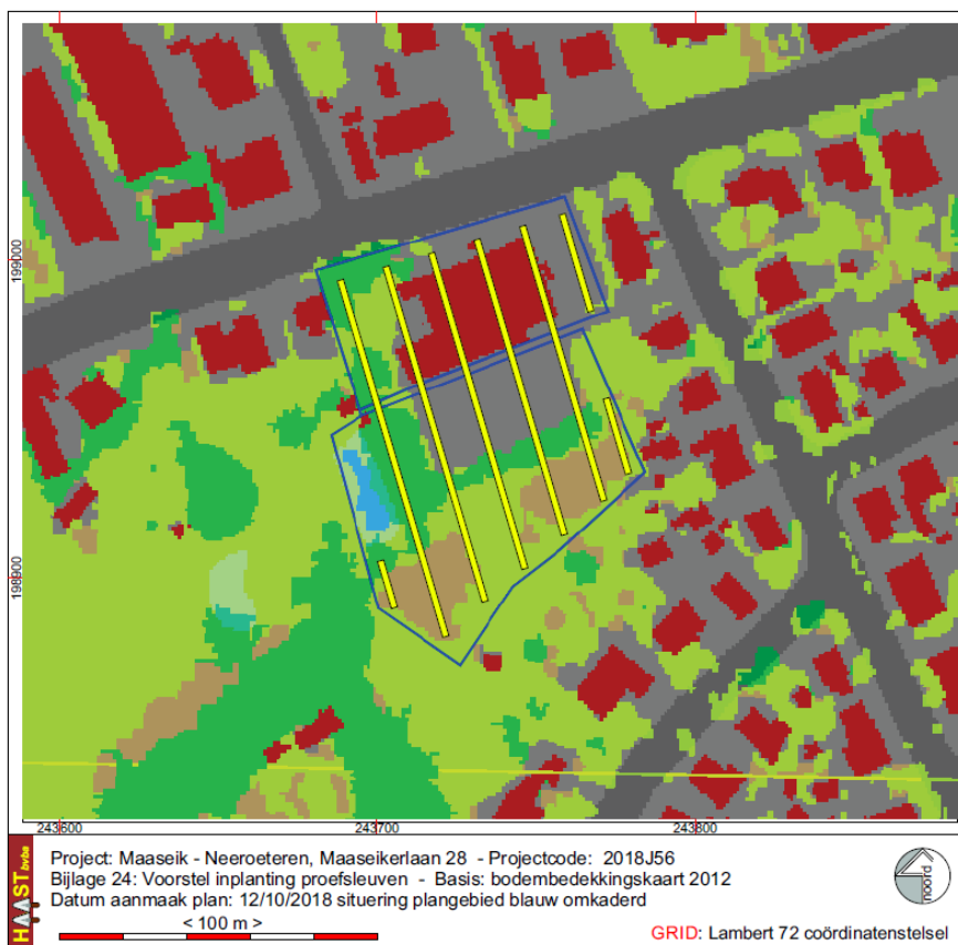
Fig. 33: Voorstel van inplanting van de proefsleuven
