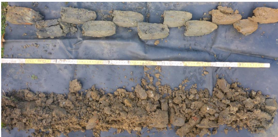
Figuur 47. Boring B2 met antropogene toplaag tot 1m diep.
