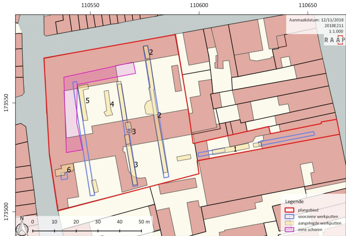
figuur 3 : Sleuvenplan geprojecteerd op het kadasterplan, projectie op het kadasterplan. In het roze de zone waar er schoren zijn geplaatst ter ondersteuning van het bestaand pand.
