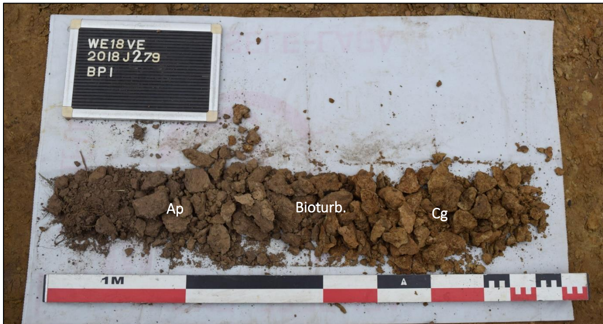
Afb. 15: Referentieprofiel BP1 met boorprofiel Ap – Bioturbatie – Cg (Bron: Aron bvba, dd. 25/10/2018, 2018J279).
