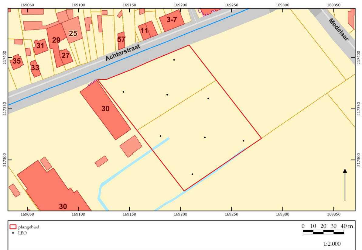
Figuur 2. Voorstel locatie boorpunten landschappelijk booronderzoek. ©LARES
