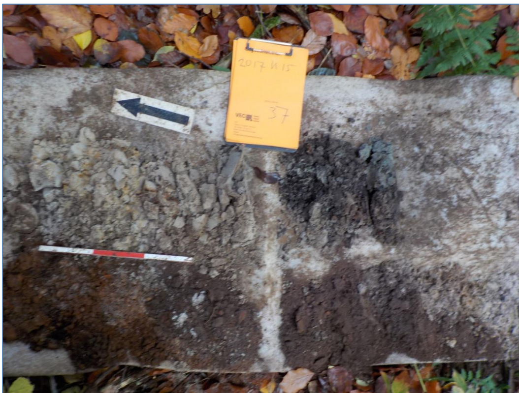
Afb. 13. De meest oostelijke boring 37 (links uitgelegd van onderen naar boven: 0-50cm, 50 – 100cm, linksboven : 100-150cm, rechts boven: 150-200cm- mv. De pijl toont het noorden.
