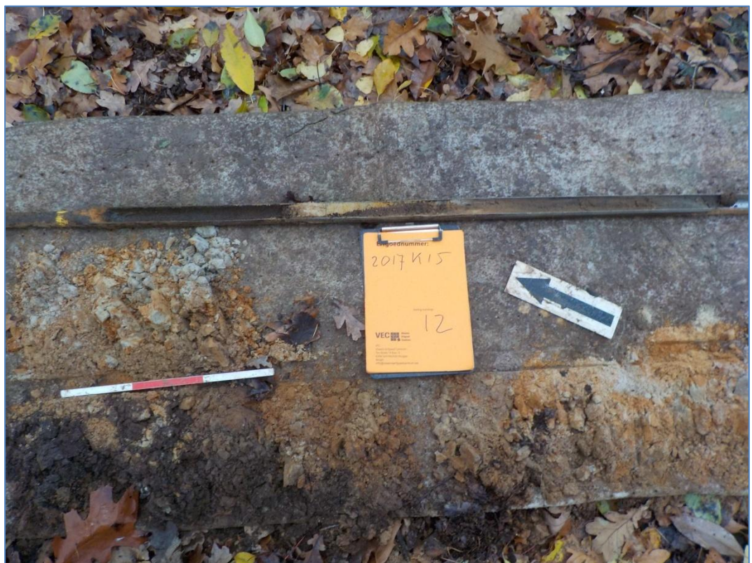
Afb. 11. Boring 12 (links uitgelegd van onderen naar boven: 0-50cm, 50 –100cm, links boven: 100-125cm, boven: guts 125-200 cm). De pijl toont het noorden.
