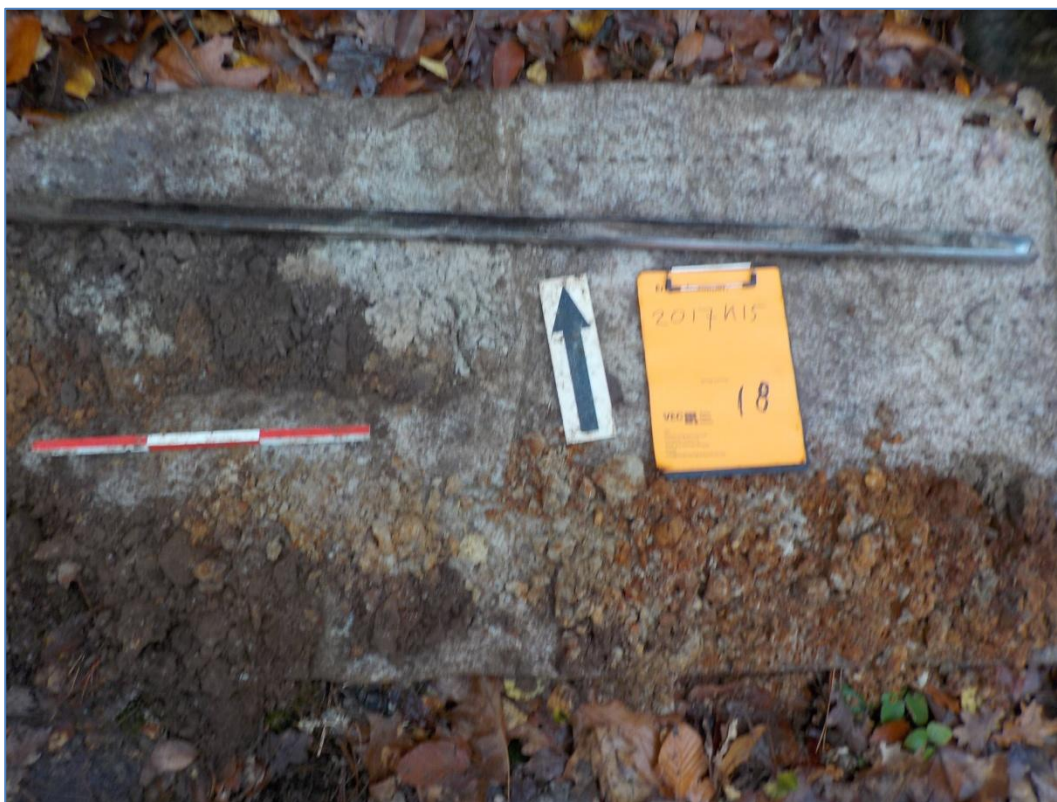
Afb. 12. Boring 18 (links uitgelegd van onderen naar boven: 0-50cm, 50 – 100cm, links boven: 100-150cm, boven: guts; 150-200cm - mv. De pijl toont het noorden.
