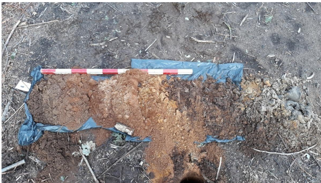
Afb. 22. Boring 312 uitgelegd van links naar rechts van 0-150 cm –Mv. Vanaf circa 80 cm –Mv (midden op de foto) is duidelijk de donkere bodemvorming in de onderliggende alluviale afzettingen zichtbaar. Hierop zijn (deels) verspoelde stuifzandafzettingen zichtbaar met veel geoxideerde ijzerdeeltjes.
