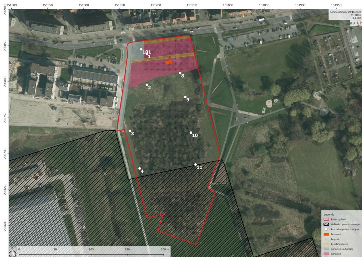
Figuur 52 Locaties uitgevoerde boringen en weergave van de recentelijk opgehoogde zone in het noordelijk deel en de verstoringen door leidingen, gebouwen en verhardingen (bron achtergrond: AGIV, 2017b)
