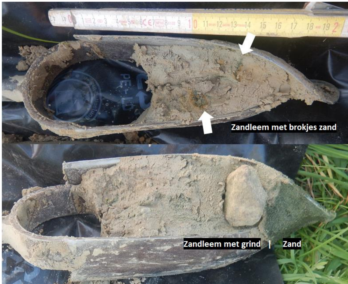
Figuur 47 Foto's van twee achtereenvolgens boven gehaalde boorkoppen in boring 9 (boven eerst). Boven : de pijlen geven aan waar er zich duidelijk sporen van cryoturbatie voor doen in de vorm van bolletjes tertiair zand omsloten door veel jongere zandleem. Onder : Interface tussen de zandleem en het tertiair substraat (groen zand in de punt van de boorkop) waar op een groot stuk zandsteen werd aangetroffen.
