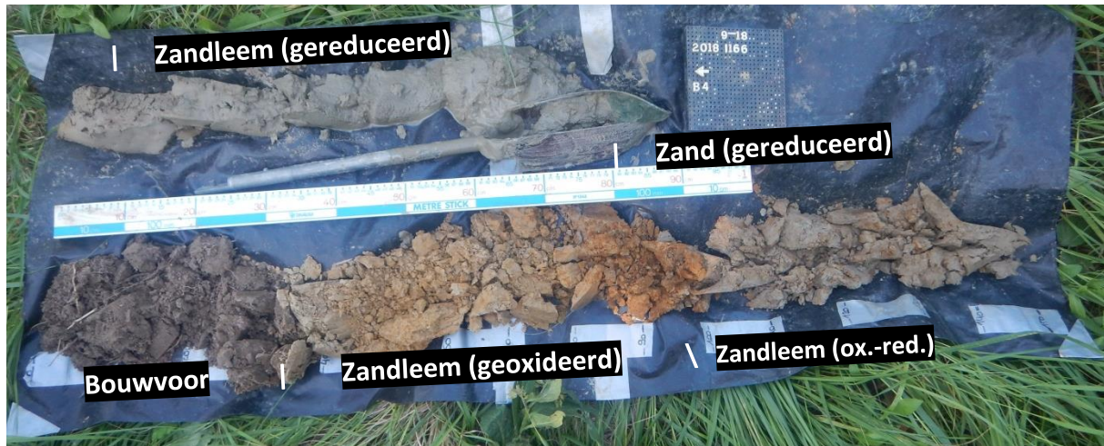
Figuur 46: Foto van uitgelegde boring 4. Hierin zijn duidelijk verschillende oxidatie-reductie niveaus af te lezen in de zandleem en is onderaan de boring (nog in de punt van de edelmanboor) het groene miocene zand zichtbaar.
