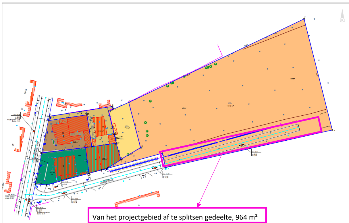
Fig. 6: opmetingsplan bestaande toestand, perceel a1332a is in haar geheel ingemeten. © Lid'1.
