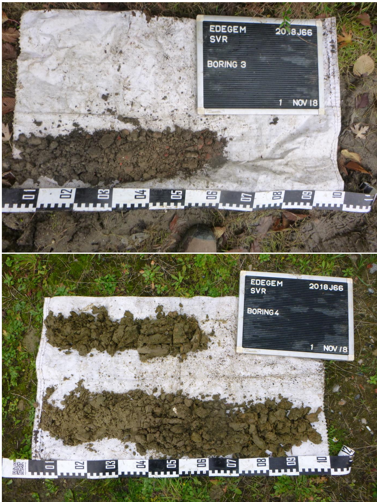
Figuur 24: Foto's van boorprofielen 1 t.e.m. 4 (bron: ABO 2018)
