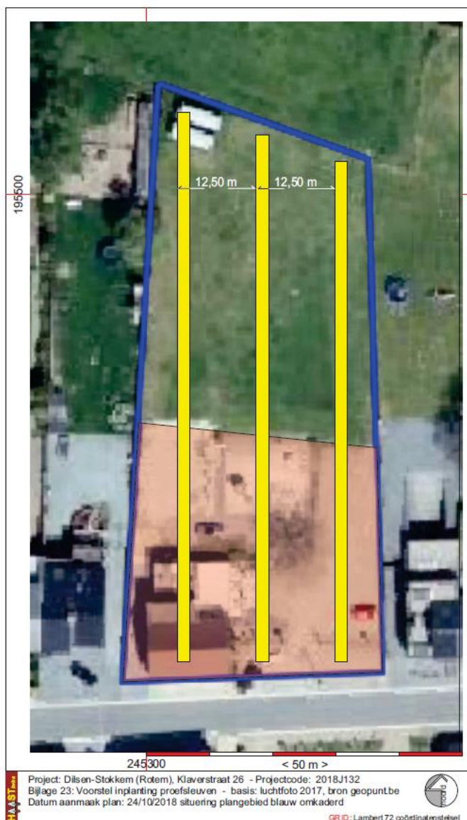
Fig. 34: Voorstel van inplanting van de proefsleuven
