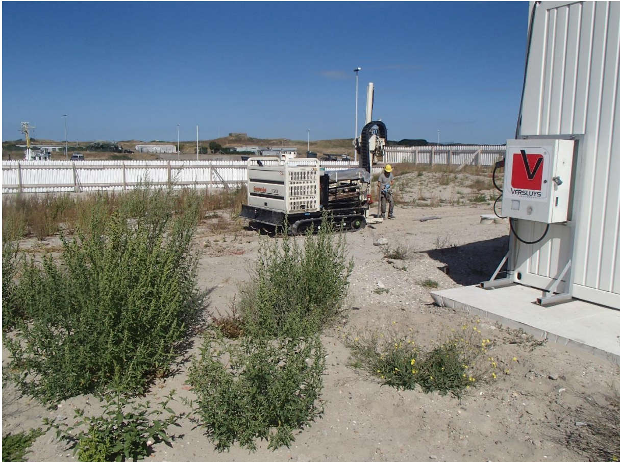
Figuur 38: Foto van de boormachine Geoprobe 7730 DT (Foto door N. Krekelbergh, 14-09-2016).
