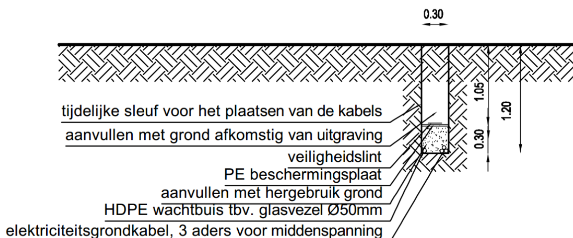
Figuur 11: Typedoorsnede van kabeltracé 12
