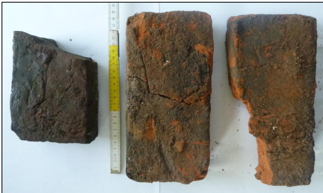
Figuur 60: Onderbakken bakstenen uit oven spoor 2.2 (rechts) en "staal" baksteen uit aanwezige muurpartij in het zuidelijk deel van het onderzoeksgebied (links) (ABO nv 2018)
