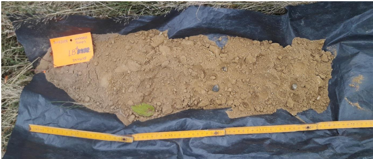
Figuur 37: Boring 1 van 0 (links) naar 70 cm (rechts) beneden het maaiveld.
