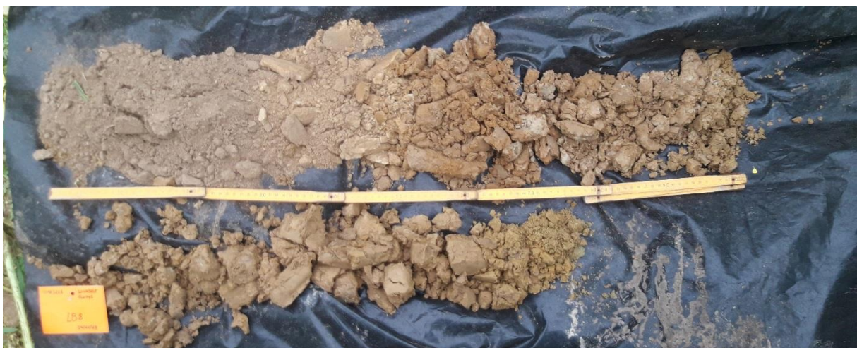
Figuur 42: Boring 8 van 0 (linksboven) naar 185 cm (rechtsonder) beneden het maaiveld.
