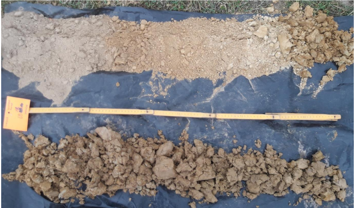
Figuur 47: Boring 13 van 0 (linksboven) naar 200 cm (rechtsonder) beneden het maaiveld.
