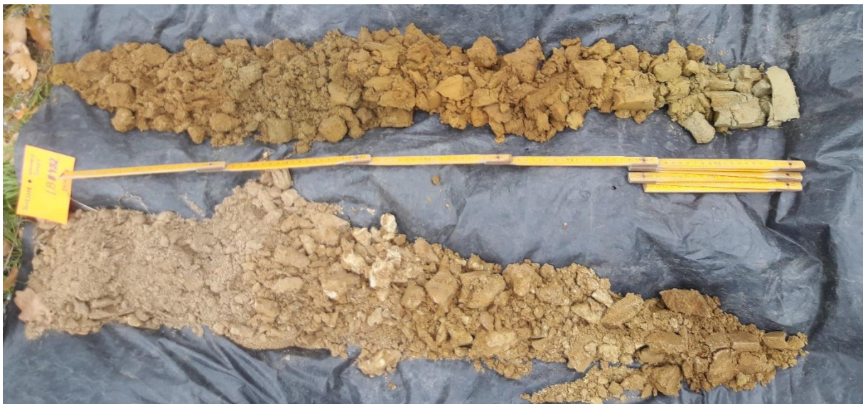
Figuur 38: Boring 2 van 0 (linksonder) naar 200 cm (rechtsboven) beneden het maaiveld.
