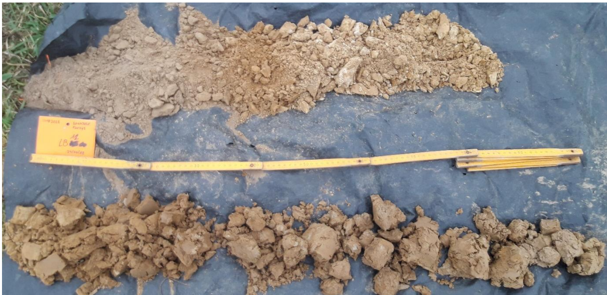
Figuur 46: Boring 12 van 0 (linksboven) naar 200 cm (rechtsonder) beneden het maaiveld.
