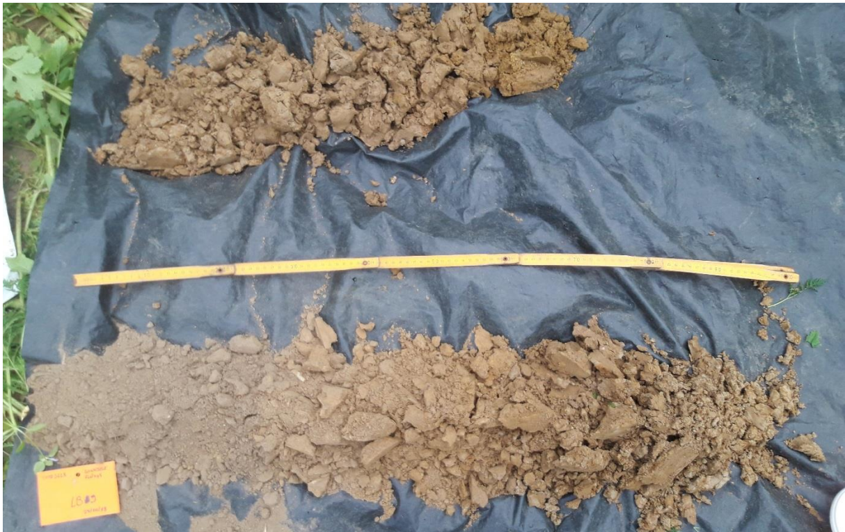
Figuur 43: Boring 9 van 0 (linksonder) naar 170 cm (rechtsboven) beneden het maaiveld.
