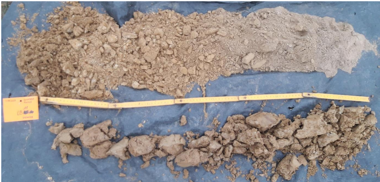
Figuur 45: Boring 11 van 0 (rechtsboven) naar 170 cm (linksonder) beneden het maaiveld.
