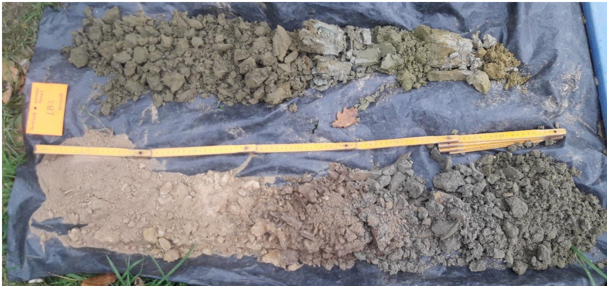
Figuur 40: Boring 5 van 0 (linksonder) naar 200 cm (rechtsboven) beneden het maaiveld.
