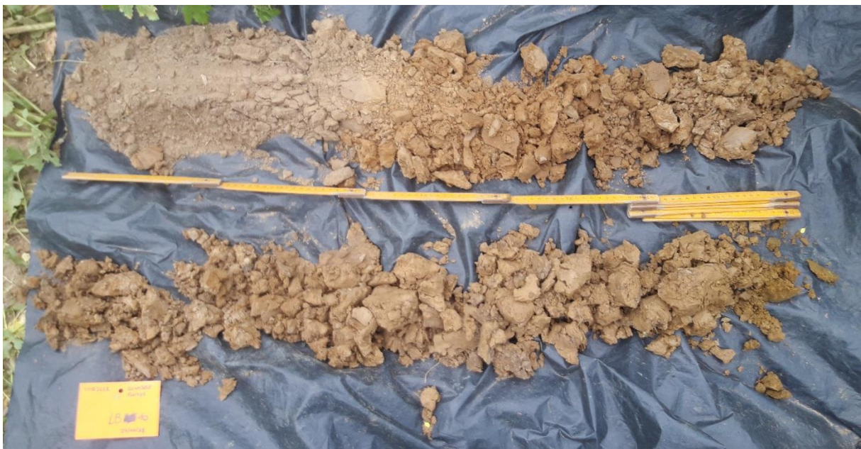
Figuur 44: Boring 10 van 0 (linksboven) naar 170 cm (rechtsonder) beneden het maaiveld.
