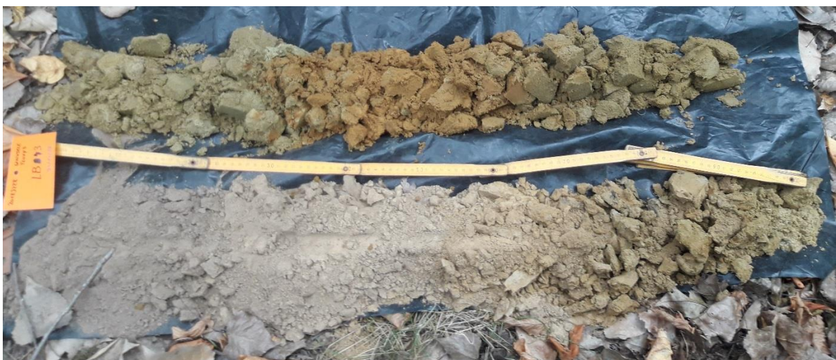
Figuur 39: Boring 3 van 0 (linksonder) naar 200 cm (rechtsboven) beneden het maaiveld.
