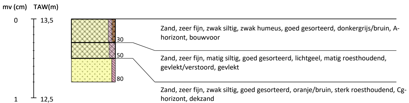
Boring 2 Lb 72-coördinaten: 178965/212155
