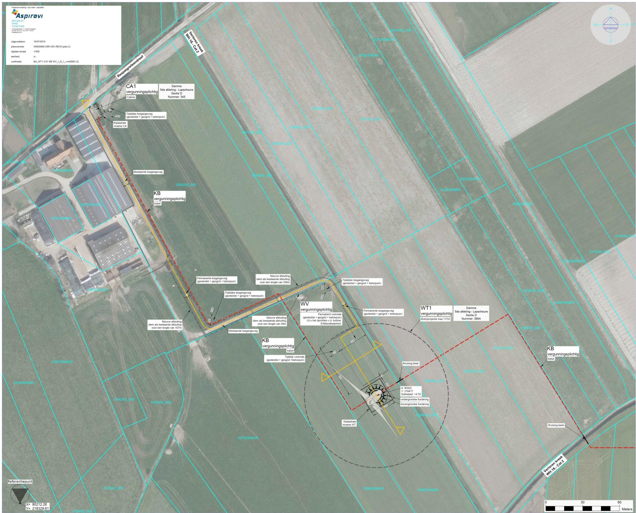
figuur 13: Ontwerpplan van de noordelijke windturbine, met aansluiting op de Respaigneleendreef (oorspronkelijke schaal 1:500, bron: Aspiravi).
