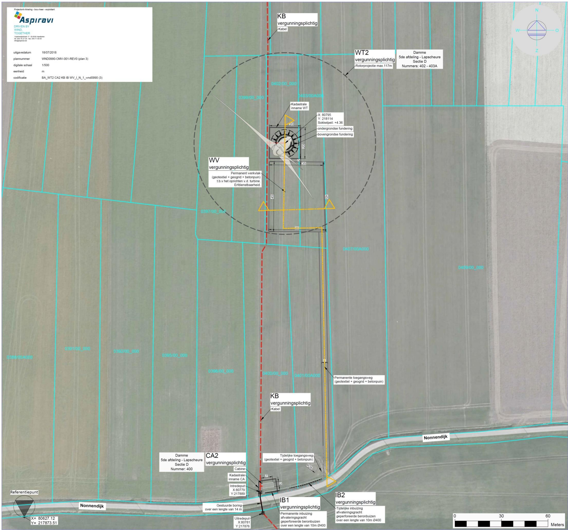
figuur 14: Ontwerpplan van de centrale windturbine, met aansluiting op de Nonnendijk (oorspronkelijke schaal 1:500, bron: Aspiravi).
