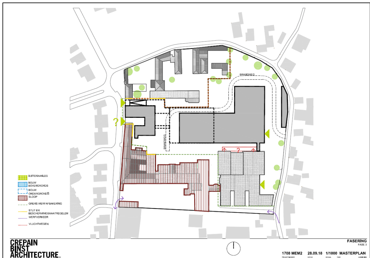
Figuur 9: Fase 3, sloop van de overige kloostergebouwen en zuidelijke ziekenhuisvleugel (donkerrood) (Bron: Initiatiefnemer, 2018).
